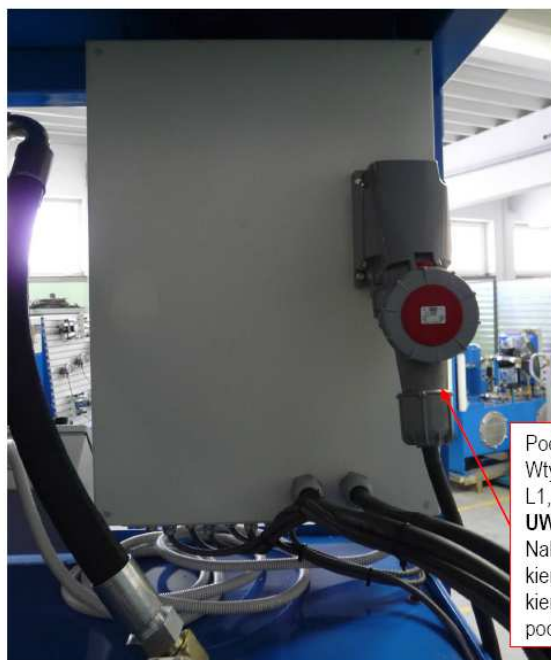
Uziemienie ochronne – zastosowano połączenie dostępnych dla dotyku metalowych części urządzeń elektrycznych w celu zapewnienia ochrony przeciwporażeniowej.
