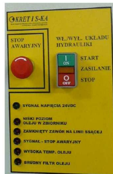
RYS.2 – układ szafy zasilającej
